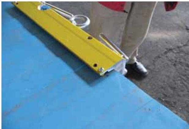
Фото № 6. Подъемный монтажный инструмент для сэндвич-панелей Ruukki при размещении в вертикальном положении.
