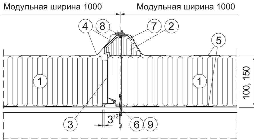
1. Наполнитель из безопасной для окружающей среды жесткой минеральной ваты, обеспечивающие высокую огнестойкость.
