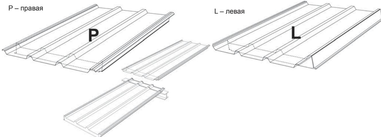
● **Соединительные элементы для монтажа панелей**
