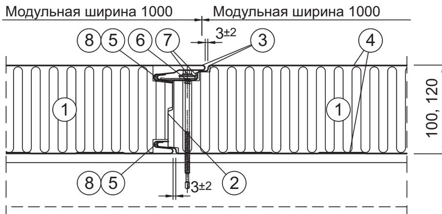
1. Наполнитель из безопасной для окружающей среды жесткой минеральной ваты с высокой степенью огнестойкости.
