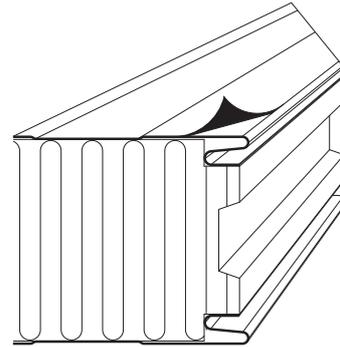
Рис. 1. Удаление защитной пленки с обшивки панелей
