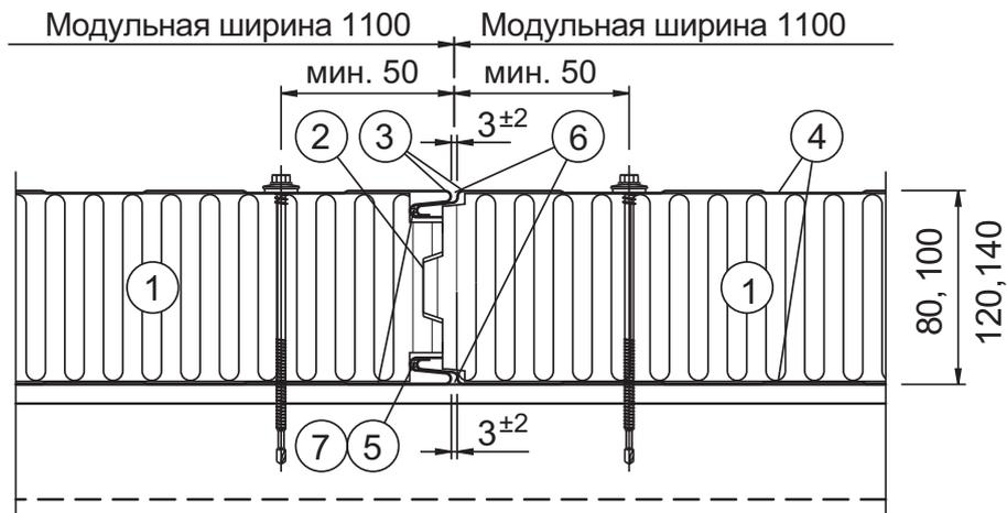
1. Наполнитель из безопасной для окружающей среды жесткой минеральной ваты с высокой степенью огнестойкости.
