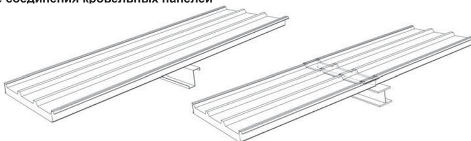
Минимальный уклон крыши для неразрезных панелей Ruukki без световых окон составляет 5%.
