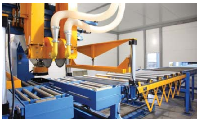
Линия по производству сэндвич-панелей Ruukki в с. Копылов
